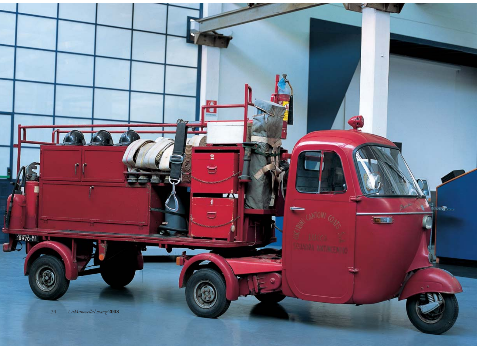
In basso, la versione antincendio del 1962 al Museo Piaggio: è equipaggiata con un motore monocilindrico a due tempi di 169, 65 cm 3 e la portata è di 650 kg.
