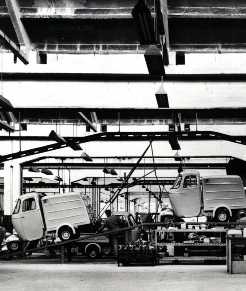
In alto, la catena di montaggio dell'Ape C1 con carrozzeria chiusa. In basso, una fila di Ape con il logo delle Olimpiadi di Roma del 1960 lascia una concessionaria di Roma. Sullo sfondo si intravede un camion carico di Vespa destinate all'evento.
